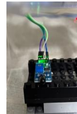
Gambar 18. Penempatan sensor LM393 sebagai pendeteksi adanya api
