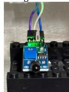
Gambar 3. Sensor IR Flame LM393 saat kondisi normal
