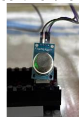
Gambar 19. Penempatan sensor MQ2 sebagai pendeteksi Adaya asap
