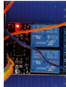
Gambar 7. Relay Low Ketika sensor mendeteksi adanya api dan melebihi nilai batas dalam ruangan Gudang Sumber : Penulis (2025)
