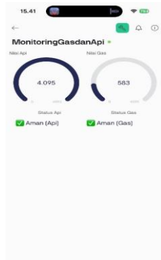
Gambar 4. Tampilan sensor LM393 pada blynk saat kondisi normal Sumber : Penulis (2025)
