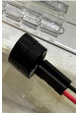
Gambar 21. Penempatan buzzer sebagai pemancar suara untuk pemberitahuan jika terjadi tanda bahaya Sumber : Penulis (2025)
