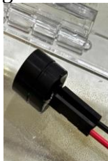
Gambar 16. Buzzer menyala Ketika nilai sensor sesuai dengan batas yang ditentukan
