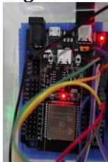
Gambar 23. Penempatan ESP32 dan Baseplat PCB digunakan sebagai Mikrokontroler pengolah data dan prosesor untuk interkoneksi dengan aplikasi blynk yang digunakan Sumber : Penulis (2025)
