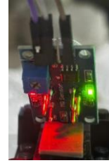
Gambar 11. Sensor MQ2 saat kondisi terdeteksi asap
